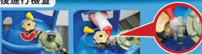
1. 輕輕用手拉動及轉動調壓器檢查，確保與瓶閥緊密接合
